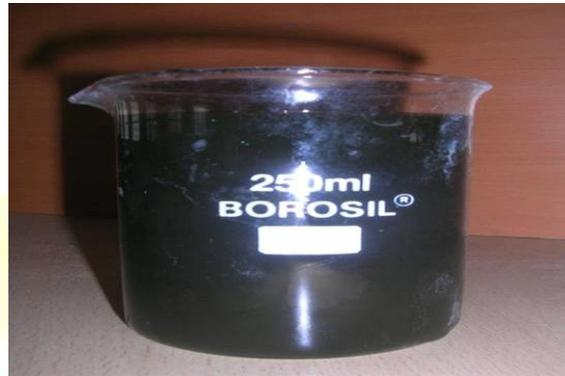
**Fig.5.4 SUPER PLASTICIZER CONPLAST SP 337, SULPHONATED NAPHTHALENE POLYMERS**
